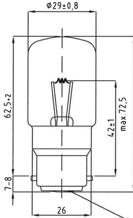
Höhenunterschied der beiden lötkontakte maximal 0,5mm
